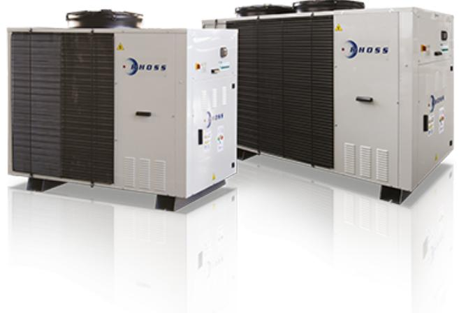
**Enfriadoras de agua y bombas de calor reversibles monobloque con condensación por aire y ventiladores helicoidales. Serie de compresores herméticos scroll DC inverter y gas refrigerante R410A.**
